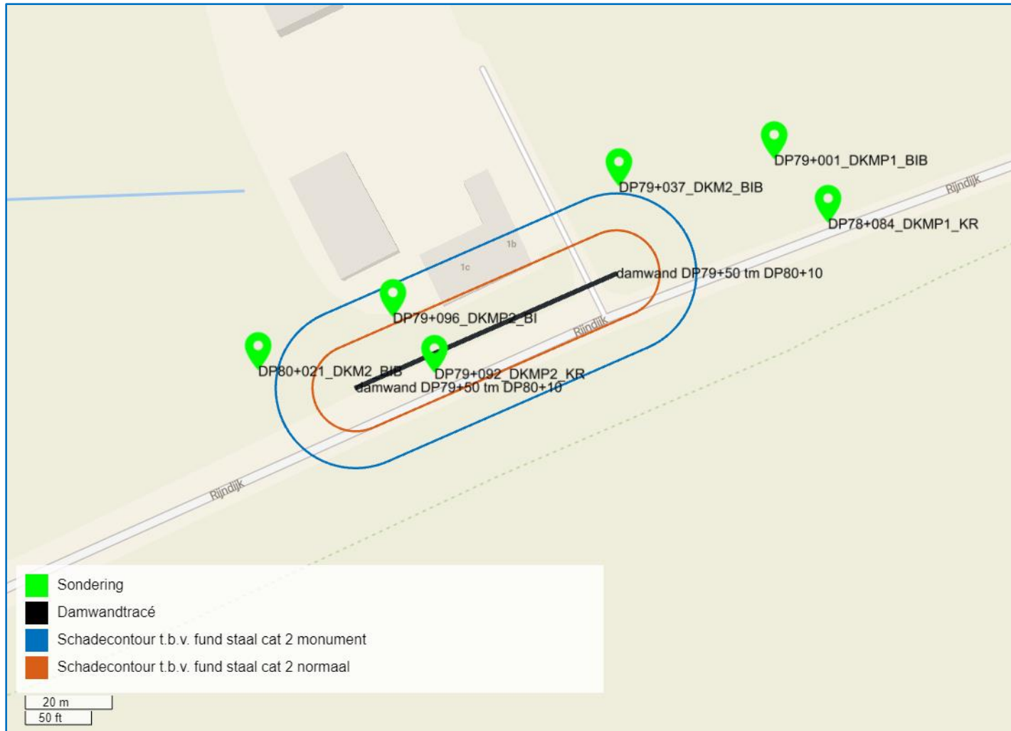
Locatie damwand DP79+50 tm DP80+10 (maatwerk)
