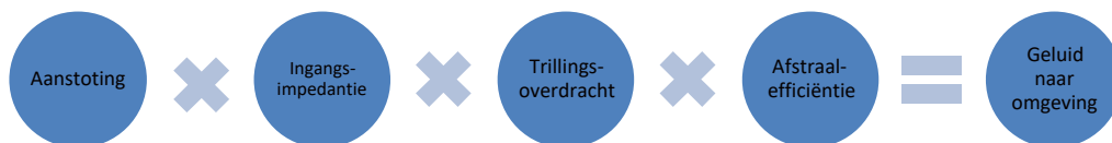
figuur 5 Vereenvoudigde beschrijving van het ontstaansmechanisme van geluid van een brug bestaand uit een keten van gebeurtenissen en brugeigenschappen
