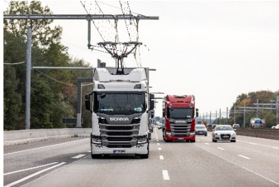
figuur 13: Proefopstelling opladen via bovenleiding
