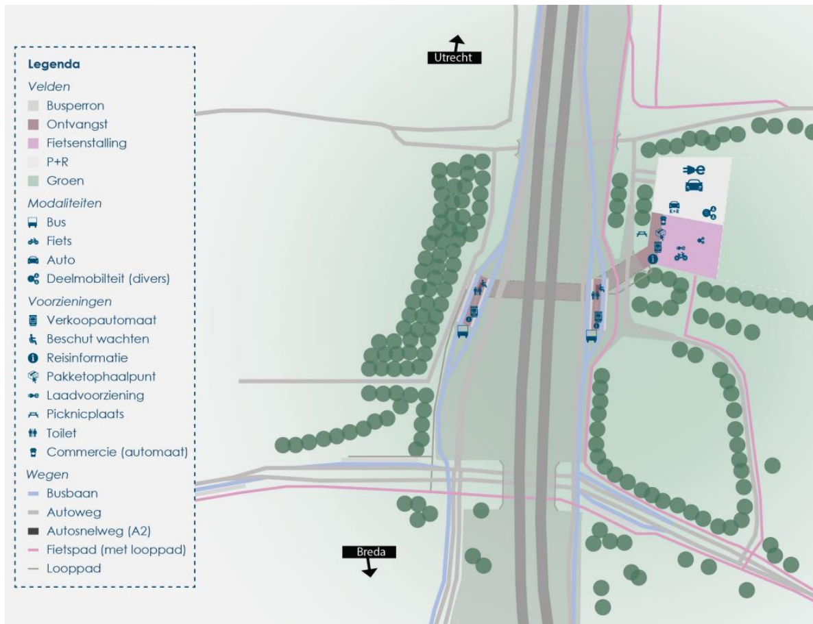
Figuur 1 Principe ontwerp Stadsgewestelijke hub toegepast op Vianen
