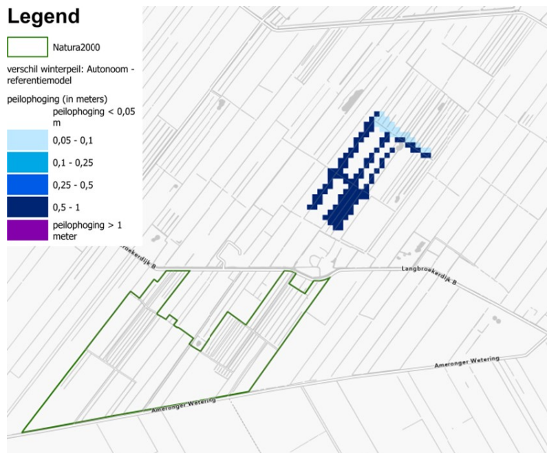
Figuur B 5-5 Verschil in winterpeilen tussen de autonome situatie en referentiemodel.
