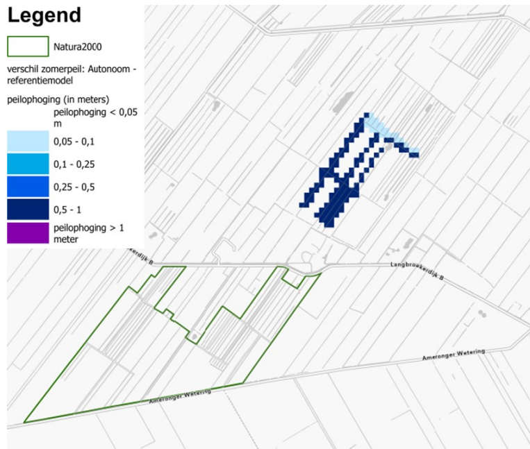
Figuur B5-4 Verschil in zomerpeilen tussen de autonome situatie en referentiemodel.
