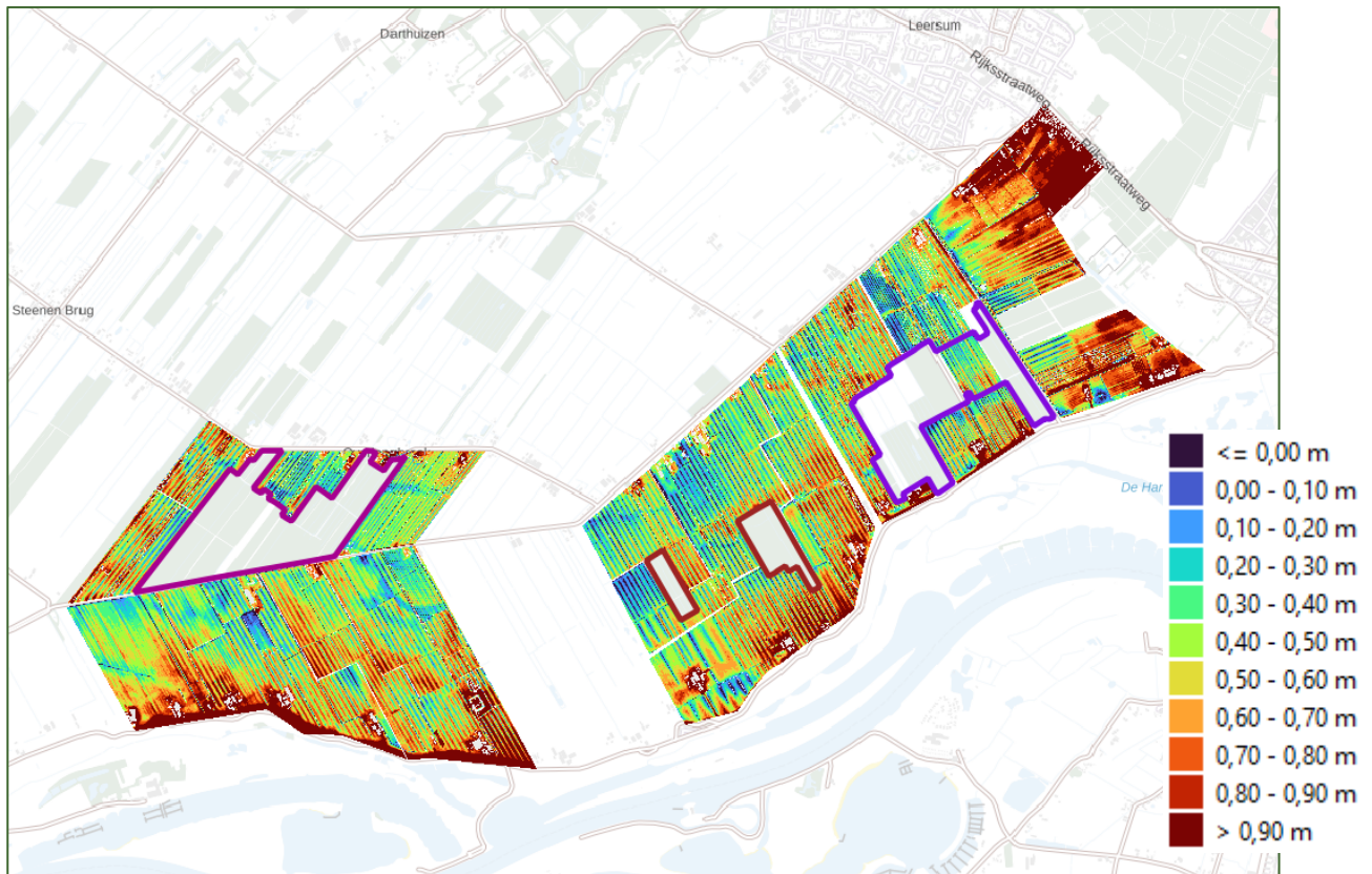
Figuur 4-2 Drooglegging in bouwsteen 1.
