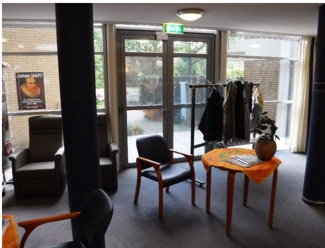
Afbeelding 3: aanwezigheid van meubilair in een vluchtroute.
