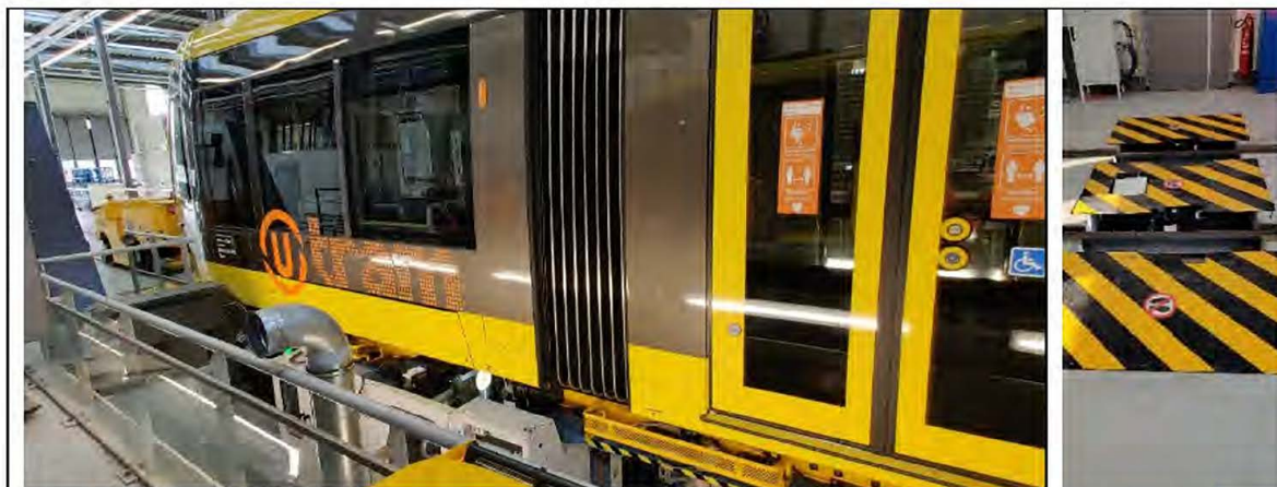
Figuur 8-4 Links: wiel-slijpinstallatie met sensoren voor trams – Rechts: sensoren voor geautomatiseerde metingen aan wielen
