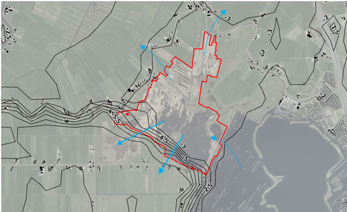
Figuur 3-6. Isohypsenkaart met rood omlijnd Botshol. De stijghoogte is aangegeven in m t.o.v. NAP. De blauwe peilen geven de overheersende grondwaterstromingsrichting aan (bron: www.grondwatertools.nl ; geraadpleegd in 2023).
