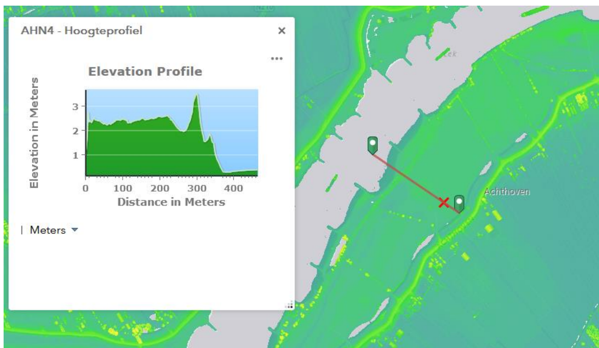
Figuur 3-11. Hoogtekaart met een figuur van het hoogteprofiel op een dwarsdoorsnede van dijk tot rivier in de Achthovense uiterwaarden. Bron: AHN4, geraadpleegd in 2021.
