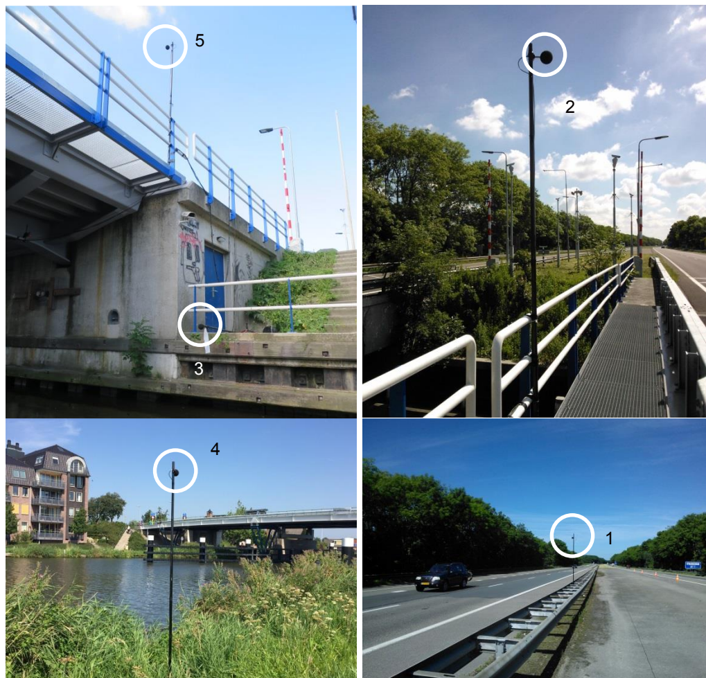
figuur 8 Opstelling microfoons bij geluidmetingen aan bruggen
