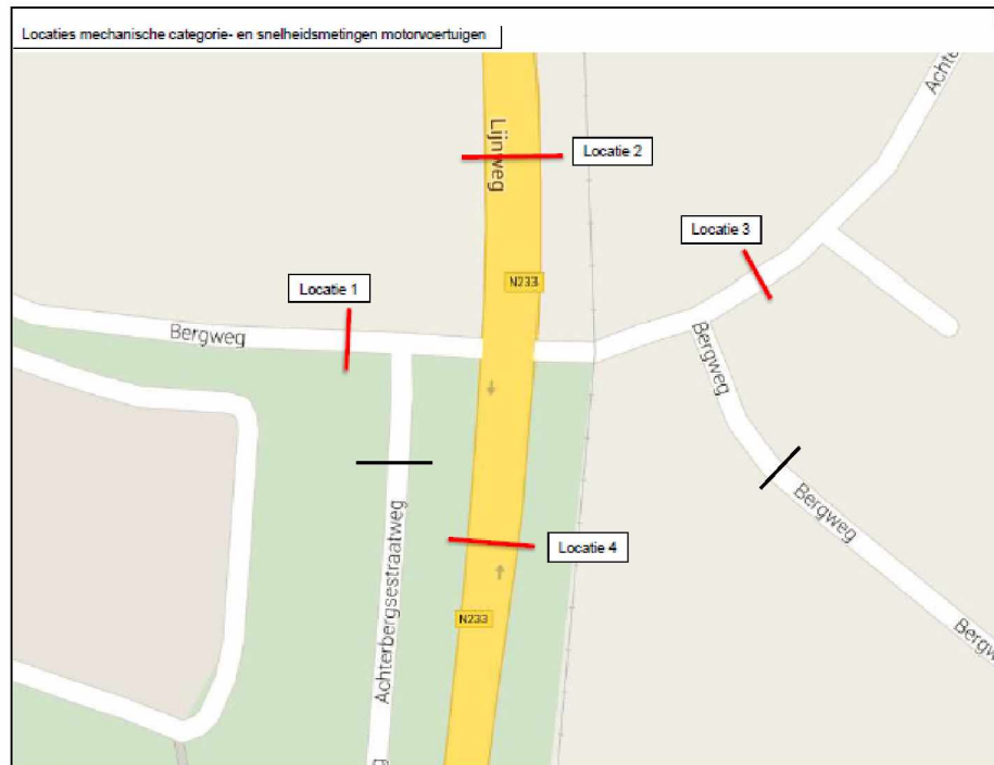
Afbeelding 5.2. Meetlocaties voor meetlussen voor mechanische tellingen op het kruispunt N233-Bergweg/Achterbergsestraatweg.
